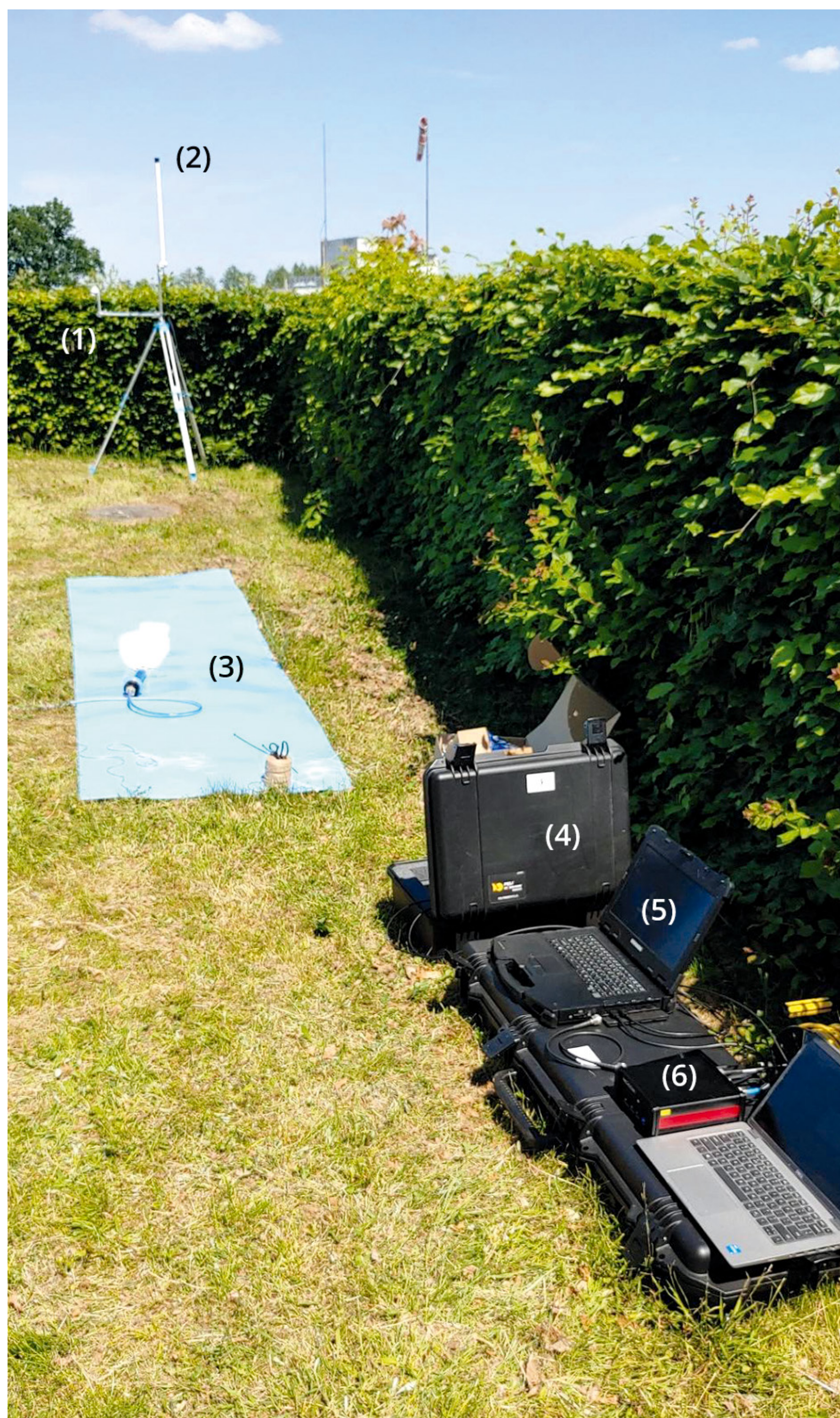
Zestaw MSRA. Na rozstawionym trójnogu po lewej antena GPS (1), po prawej Antena UHF 360° do łączności z radiosondą (2). Poniżej stanowisko do napełniania balonów (3). Po prawej od góry: Groundcheck – system weryfikacji i konfiguracji radiosond (4); sterowanie systemem wizualizacji danych (5); odbiornik danych (6). (fot. Jerzy Jutarski).
