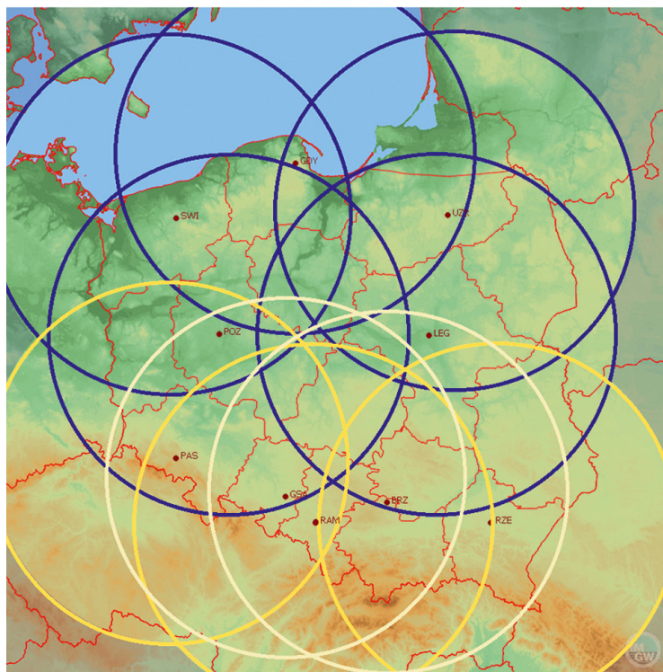
Obszar domeny sieci POLRAD – na górnej grafice zasięg skanowania dopplerowskiego (125 km), na dolnej – zasięg skanowania klasycznego (250 km), kolor niebieski to radary pokrywające skanowaniem obszar północnej i centralnej Polski, a kolory w odcieniu żółtym – Polski południowej.
