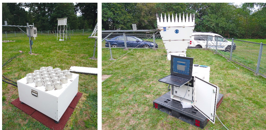
Po lewej antena sodaru z 24 głosiłkami, po prawej na pierwszym planie jednostka sterująca sodaru, w tle antena z zamontowaną osłoną akustyczną. (fot. Grzegorz Zabłocki).
