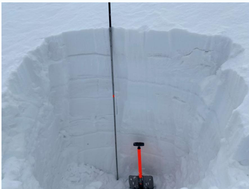
Fot. 11. Profil stratygraficzny pokrywy śnieżnej wykonany 11 marca 2026 na progu Kotlinki Świnickiej w kierunku Czerwonych Stawków.
