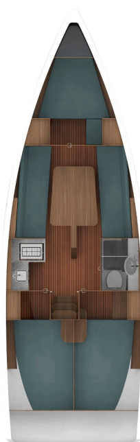
Schemat jachtu żaglowego Antila 33.3 (10,5 m), pokazujący rozplanowanie pomieszczeń pod pokładem i obrazujący liczbę miejsc do spania ( https://regatowemazury.pl/czarter-jachtu-antila-33/ ).
