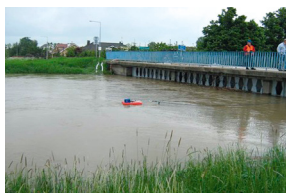
POMIARY HYDROMETRYCZNE MŁYNKIEM HYDROMETRYCZNYM Z MOSTU
