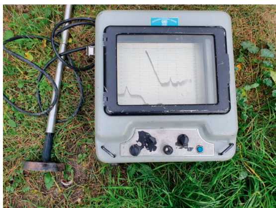
Rys. 6.1.10. Echosonda Raythenvon Company So. San Francisco model DE-719. Fot. B. Nowak.
