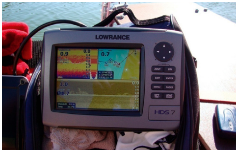
Rys. 6.2.3. Wyposażenie podczas pomiarów echosondą: obrazy dna jeziora na wyświetlaczu Full VGA SolarMAX™ PLUS TFT (a); łódź Texas 360 (b).
