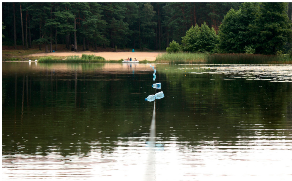
Rys. 6.1.4. Sondowanie profilu poprzecznego jeziora wzdłuż rozciągniętej linii z pływakami.
