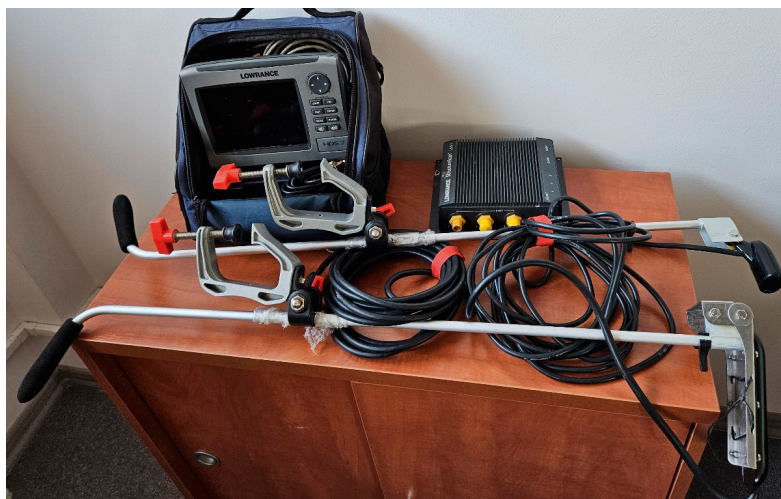
Rys. 6.1.14. Zestaw HDS-7Combo GPS z sonarem bocznym LSS-1Structure Scan. Fot. B. Nowicka
