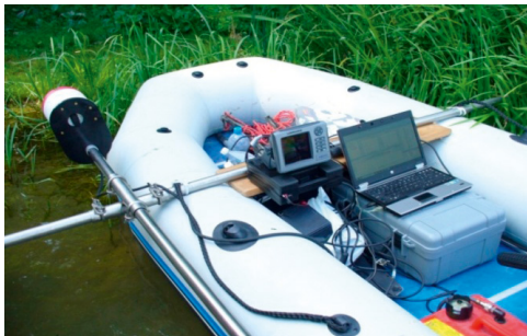
Rys. 6.1.12. Ponton pomiarowy z ADCP, echosondą Lowrance i komputerem pracującym jako chart-ploter (a). Głowica ADCP zamontowana do pontonu (b). Fot. A. Magnuszewski.
