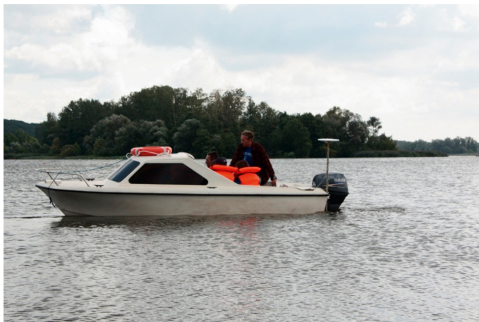
Rys. 6.1.8. Ruchoma antena DGPS zamontowana na rufie łodzi. Fot. B. Nowicka.
