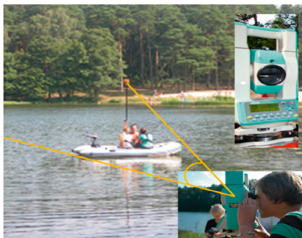
Rys. 6.1.7. Pozycjonowanie pontonu pomiarowego przy wykorzystaniu tachimetru elektronicznego Nikon. Fot. B. Nowicka.
