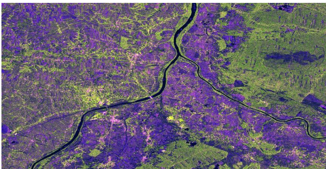
Fot. 2. Fragment obrazu przedstawionego na fotografii 1 w pełnej rozdzielczości przestrzennej. Kompozycja RGB: VV-VH-VV/VH przygotowana na podstawie danych SAR/Sentinel-1 odebranych w Krakowie (25.11.2020, 4:45 UTC); opracowanie P. Struzik, IMGW-PIB
