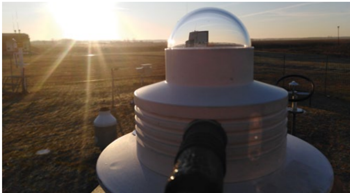
Czujnik UV Biometer Model 501 mierzący erytemalne promieniowanie UV-B, zainstalowany w ogródku meteorologicznym stacji SHM Łeba (fot. J. Biszczyk-Jakubowska)
