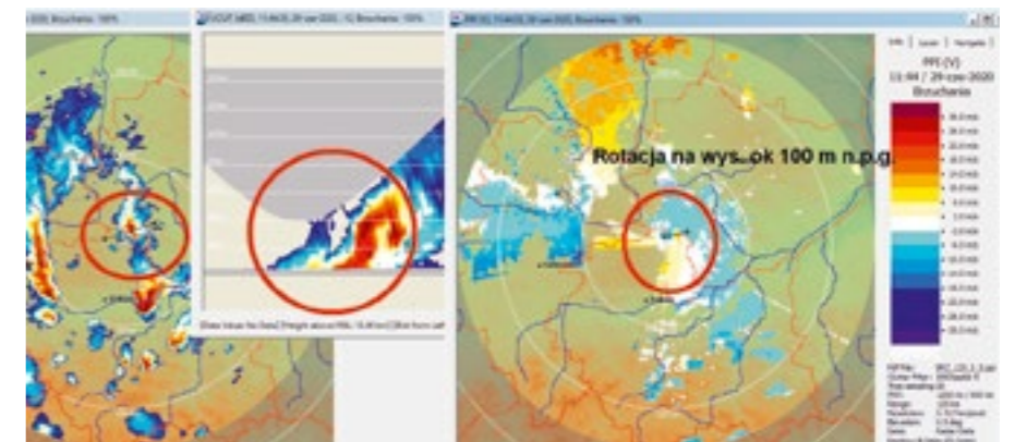
Obraz z radaru meteorologicznego z sygnaturą BWER (ang. Bounded Weak Echo Region) prezentujący obudowane pasmo słabego echa podczas burzy, która 29 czerwca 2020 roku przeszła na północ od Krakowa. Takie słabe echo jest świadectwem bardzo silnego prądu wznoszącego, który rozprasza na boki hydrometeory. Na grafice po prawej stronie zaznaczono rotację zarejestrowaną na wysokości 100 m n.p.g. – świadectwo dużego prawdopodobieństwa trąby powietrznej
