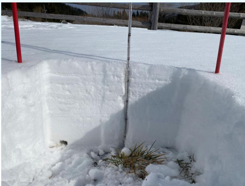
Fot. 12. Profil stratygraficzny pokrywy śnieżnej wykonanego 4 marca 2026 w ogródku pomiarowym SBŚL Hala Gąsienicowa.
