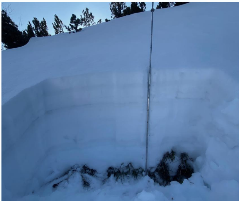
Fot. 11. Profil stratygraficzny pokrywy śnieżnej wykonanego 3 marca 2026 w dolnych partiach stoków Uhroci Kasprowych w pobliżu SBŚL Hala Gąsienicowa.
